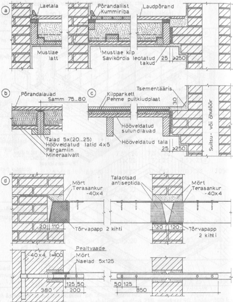
Joonis 65. Puitvahelae detaile: a — külginemine tellisseina ja korstnaga; b — ilma alumise puhasvoodrita lagi; c — nähtavale jäetud taladega, soojustuseta lagi; d — laetalade ankurdus
