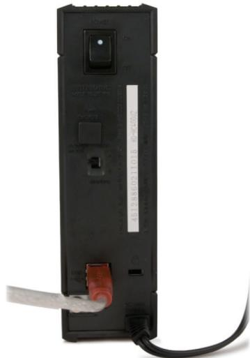
Ligue o cabo USB ou firewire ao Mac ou outro dispositivo ao qual a DriveStation está a ser adicionada.
